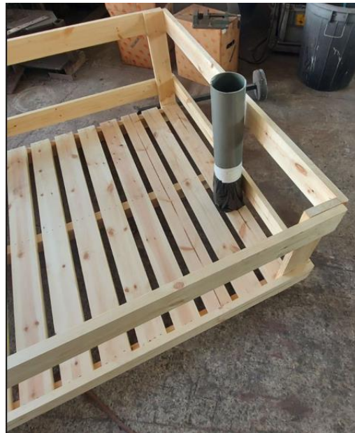
Εικόνα 10 Σχέδιο εγκατάστασης των φυτών εντός των σωλήνων φύτευσης (επάνω) και έτοιμοι σωλήνες από το Τμήμα Δασών (αριστερά). Η πλατφόρμα διατήρησης των σωλήνων κατά την παραγωγή θα χρησιμοποιείται και για εύκολη φόρτωση των σωλήνων σε φορτηγό με χρήση forklift (δεξιά)
