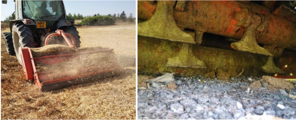
Εικόνα 5 Χρήση καταστροφέα ως μια επιλογή για την αντιμετώπιση της δευτερογενούς βλάστησης και δημιουργίας εδαφοκάλυψης. Τα «μαχαίρια» του καταστροφέα (δεξιά).
